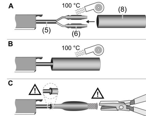
Bild 8: Ausgangsleitung des letzten Lichteinsatzes versiegeln
